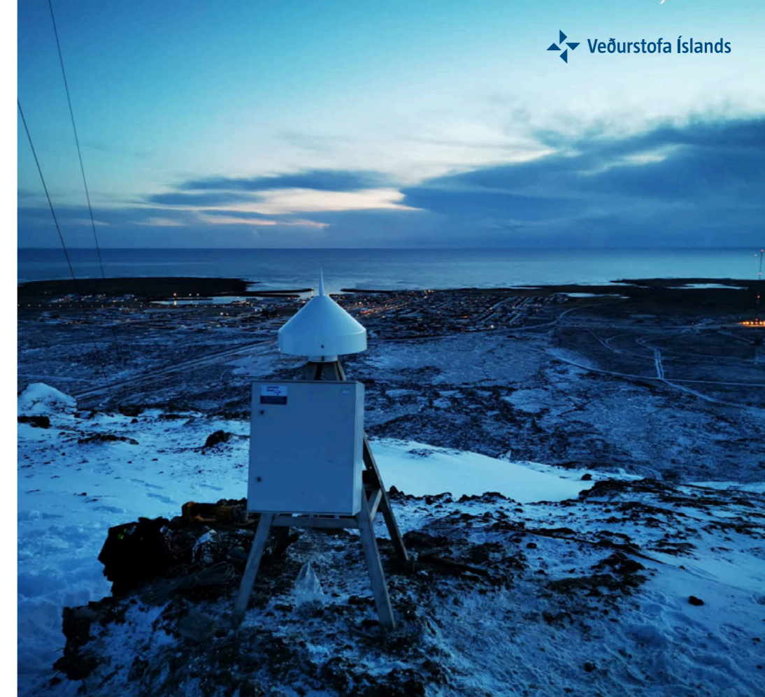
GPS mælir á toppi fjallsins Þorbjarnar í janúar 2020. GPS mælir eru hluti mælanetsins sem greinir landris. Ljósmynd: Benedikt G. Ófeigsson.
