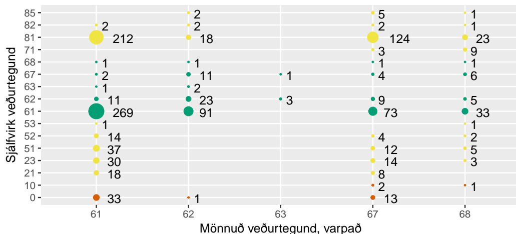
Mynd 83: Sjálfvirkar mælingar sem fall af rigningu á athugunarstað skv. mannaðri athugun.
