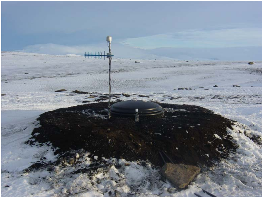
Mynd 3. Ytri frágangur jarðhýsis. Stöng fyrir GPS-klukku og móttaldsloftnet er staðsett við hlið jarðhýsisins.
