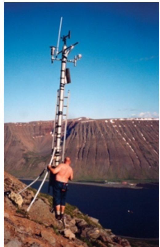
Hér er Elvar Ástráðsson vélfræðingur að dytta að sjálfvirkri veðurstöð í Seljalandsdal ofan Skutulsfjarðar. Þessi stöð er einkar mikilvæg vegna eftirlits með snjóflóðahættu (ljósm.: Árni Sigurðsson).
