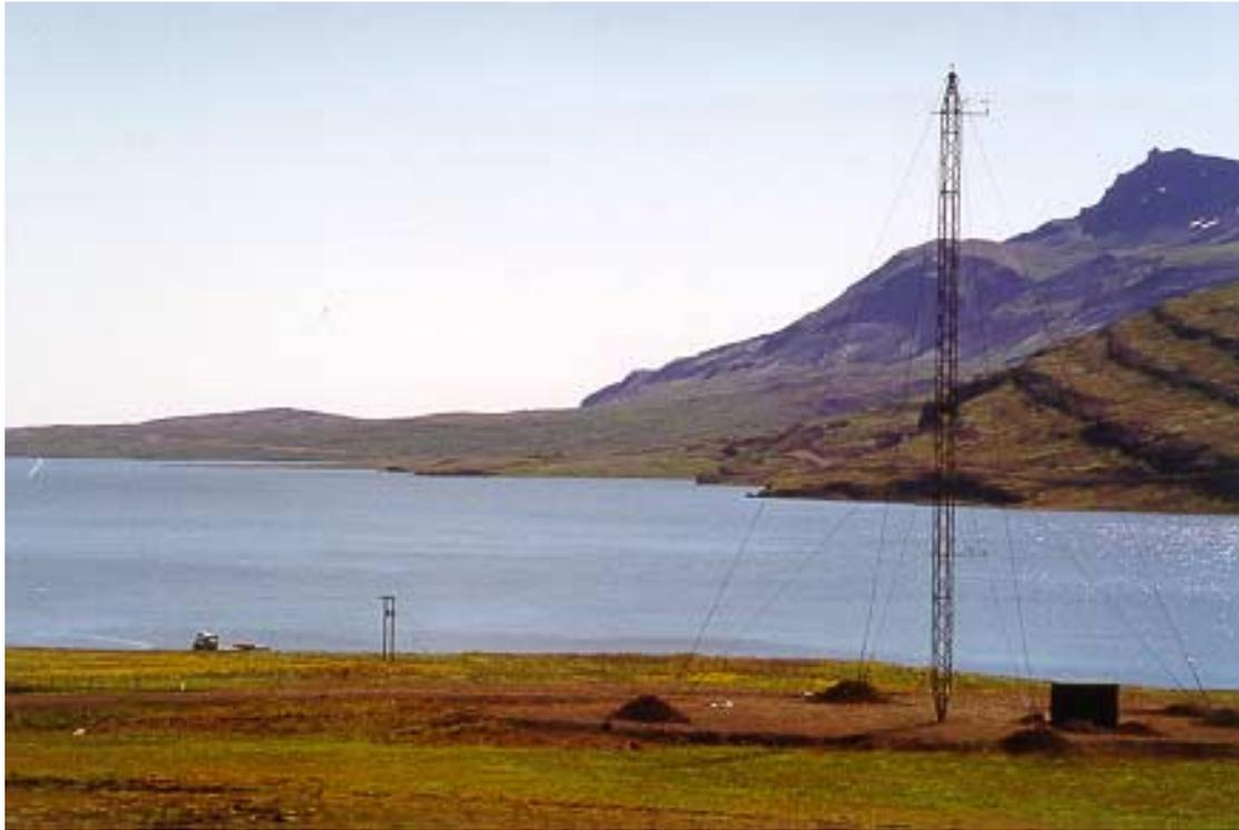
**Fig. 2.** The anemometer mast at Sómastaðagerði.
