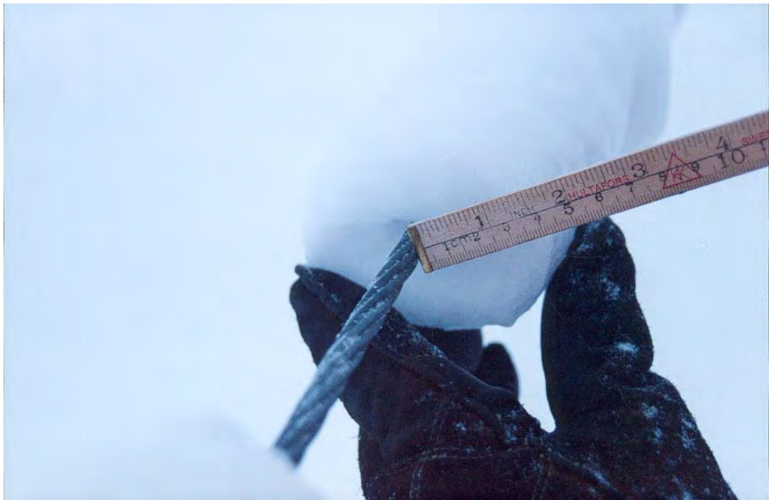
Mynd 31. Ísing á stagi 8. mars 1989. Þykkt ískápu um 4 cm. Ljós.: Kristinn Pálsson.
