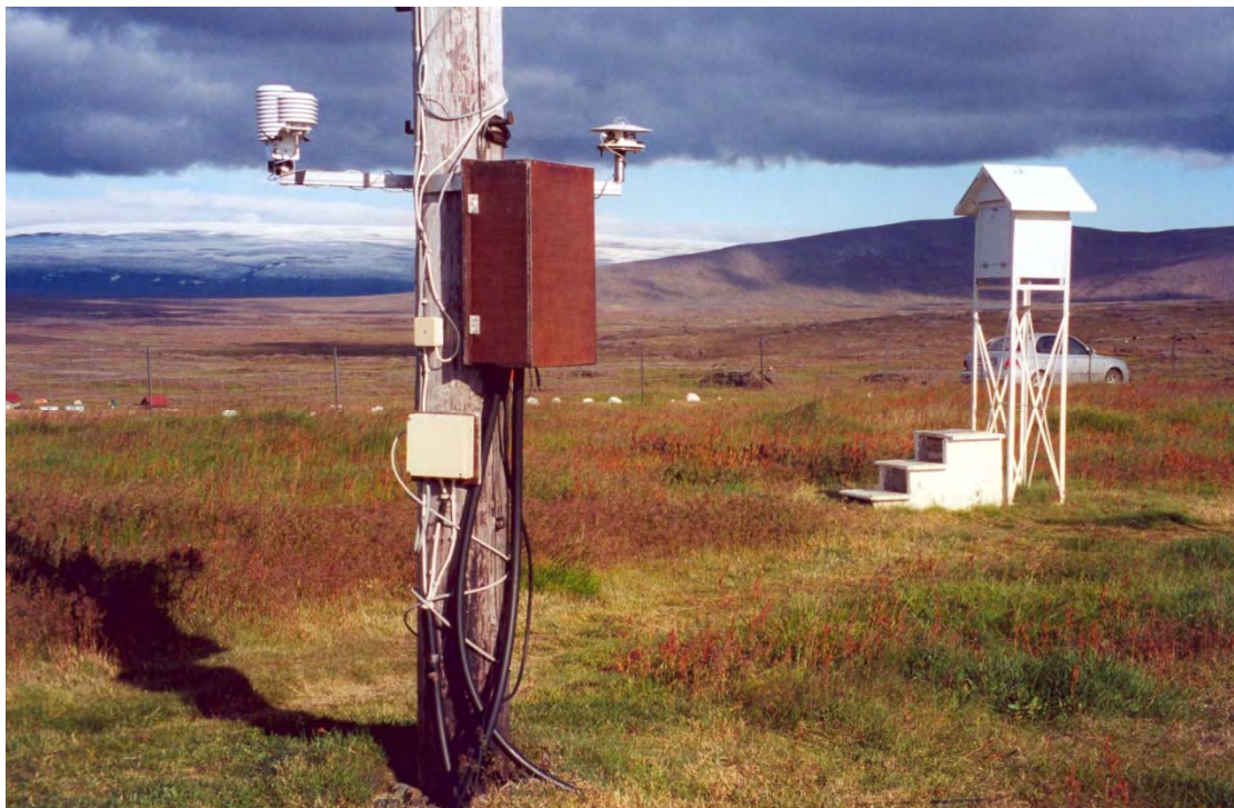
Mynd 40. Stjórneining eða stjórn tölva sjálfvirkar veðurstöðvar er í brúna hlífðarkassanum sem sést á sturnum. Á arminum til vinstri má sjá lofthita- og rakamæla, en á arminum til hægri sést sólgeislunarmælir. Ljós.: Flosi Hrafn Sigurðsson 2001.
