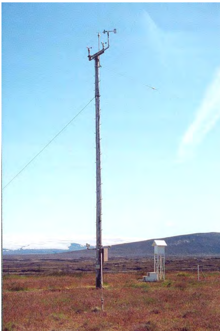
Mynd 41. Sjálfvirk veðurstöð er neðarlega á vindmælastaurnum, en vindmælarnir eru efst á honum. Ljósmynd: Flosi Hrafn Sigurðsson 2001.
