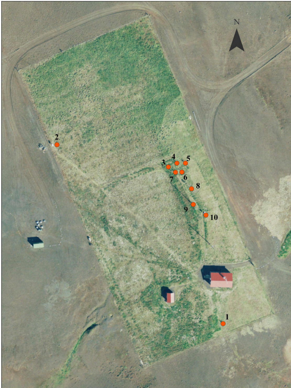
Mynd 2. Yfirlitsmynd sem sýnir staðsetningu mælitækja. 1: Sólskinsstundamælir, 2: Jarðvegshitamælar, 3: Tretyakov úrkomumælir, 4: Úrkomumælir nr. 1, 5: Geonor úrkomumælir, 6: Úrkomumælir nr. 2, 7: Úrkomuriti, 8: Úrkomusafnmælir, 9: Vindmælar og sjálfvirk veðurstöð, 10: Hitamælaskýli.
