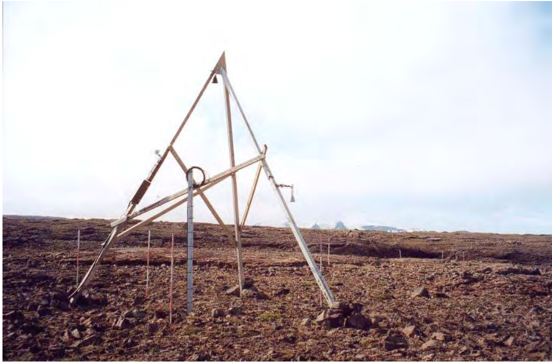
Mynd 39. Fyrirkomulag sjálfvirkra snjódýptarmæla. Ljós.: Flosi Hrafn Sigurðsson.
