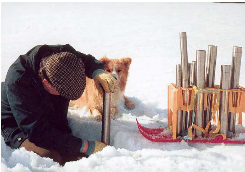
Mynd 28. Árni Stefánsson tekur snjósýni til ákvörðunar á eðlismassa snævar. Ljós-: Guðrún Halla Guðmundsdóttir.
