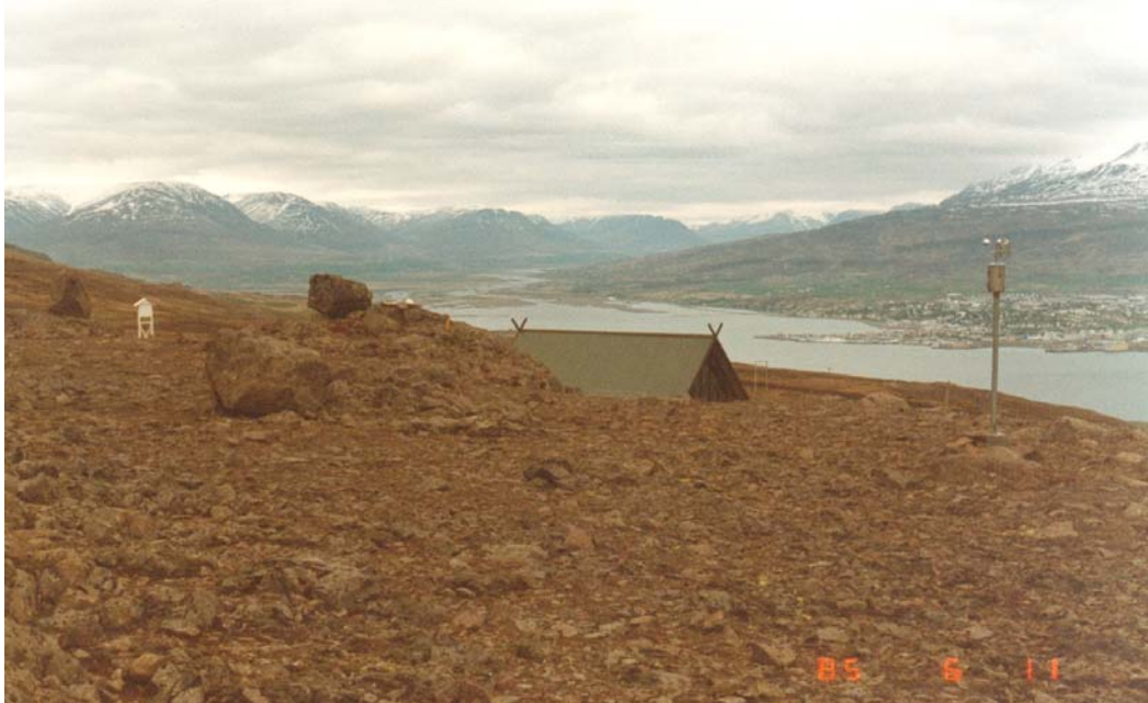
Mynd 7. Hitamælistaðurinn við sel Menntaskólans á Akureyri í 346 m hæð í Vaðlaheiði. Þar var til glöggvunar einnig settur upp síritandi vindmælir í 2 m hæð yfir jörð eins og sjá má til hægri á myndinni.
