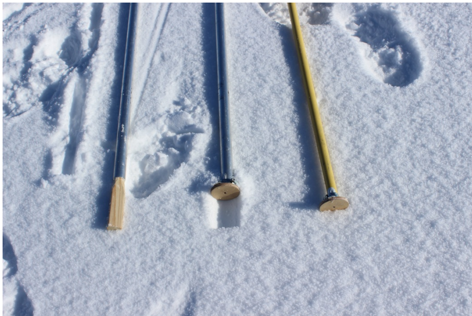
Mynd 3 b. Ein samanburðarstikanna var látin standa á trékeilu (stikan t.v.) en hinar tvær á kringlótttri krossviðarplötu (álstikan í miðið og plaststikan). Þvermál trékeilu er hið sama og álstikunnar, 3.2 cm, en þvermál krossviðarskífunnar 6 cm. Aðalstikan stóð á trékeilu líkt og stikur í öðrum mælipunktum á jöklinum.
