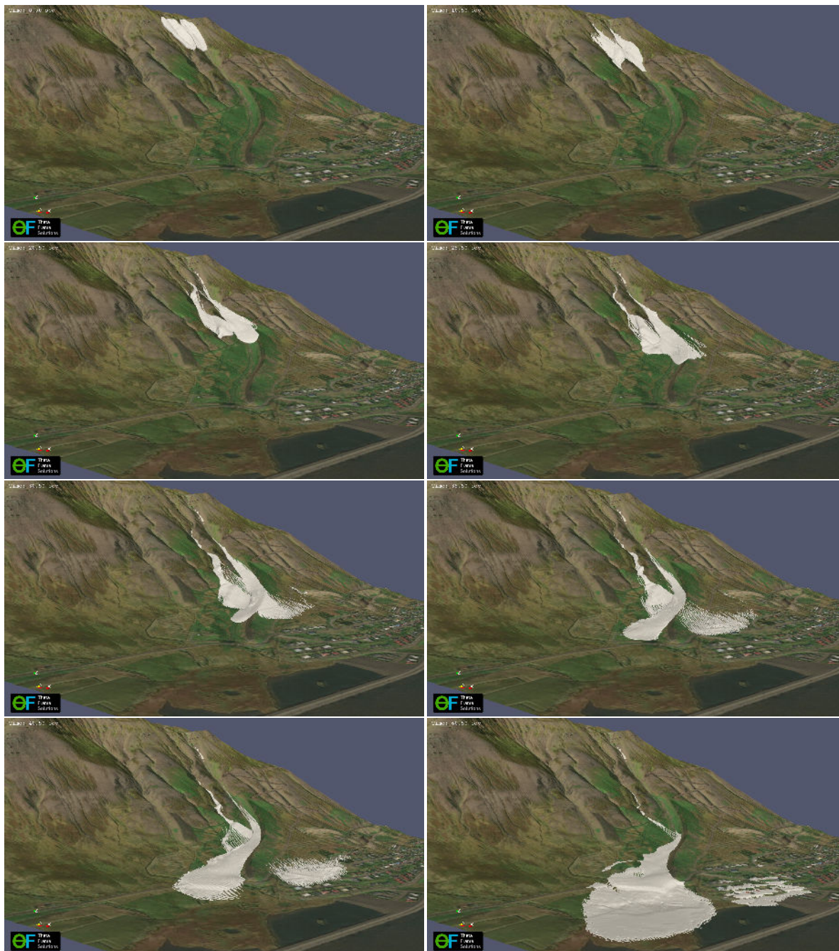
Mynd 9. Nokkur tímaskref í líkanreikningum á hönnunarsnjóflóði úr Strengsgiljum sem lendir á Stóra-Bola með þvíða snjóflóðalíkaninu Open- \mu(I) . Sjá má að snjóflóðið myndar stríðan streng með dýpra streymi sem breikkar niður með garðinum og að svokallað straumstökk myndast þar sem aðstreymi úr Syðra-Strengsgili flæðir inn í strenginn. Flóðið reiknast flæða að hluta yfir miðjan garðinn þar sem hann sveigir til suðurs. Tími frá upphafi keyrslunnar er ritaður í efra vinstra horn hvers ramma.
