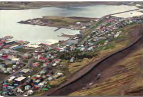
Þvergarðunum er ætlað að stöðva snjóflóð ofan byggðar. Catching dams are intended to stop avalanches above the village. (MYND S.S.)
