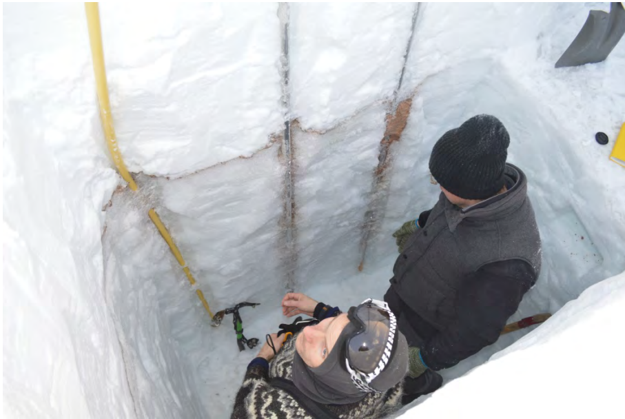
Mynd 24. Horft ofan í 2.5 m djúpa gryfju sem grafin var í haustferðinni 2014 til þess að kanna mögulega hliðrun á stikunum uppávið eða niðurávið um sumarið.
