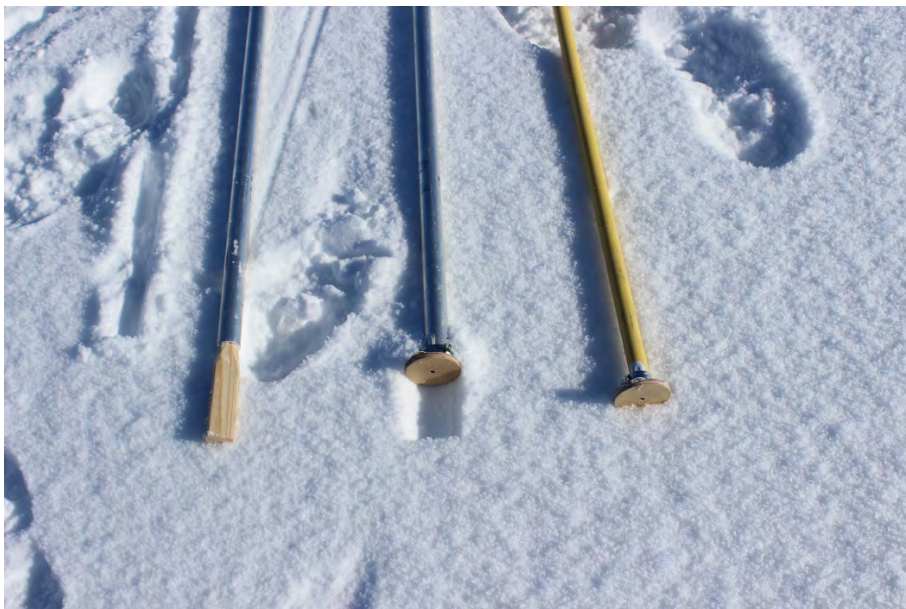
Mynd 23. Ein samanburðarstíkanna var látin standa á trékeilu (stíkan t.v.) en hinar tvær á kringlóttri krossviðarplötu (álstíkan í miðið og plaststíkan til hægri). Þvermál trékeilu er hið sama og álstíkunnar, 3.2 cm, en þvermál krossviðarskífunnar 6 cm. Aðalstíkan stóð á trékeilu líkt og stíkur í öðrum mælipunktum á jöklinum.
