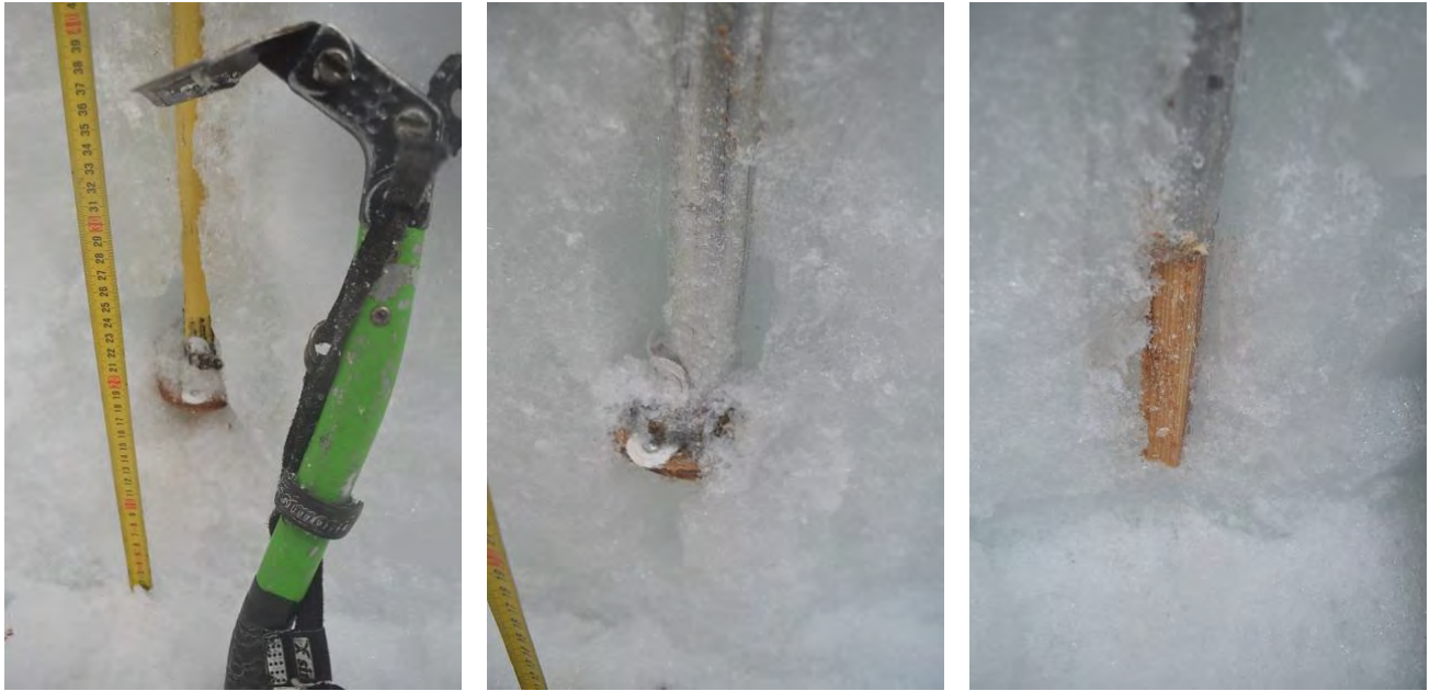
Mynd 26. Stikufætur í haustferð 2014. Greina má holrými ofan við báðar krossviðarskífurnar (plaststíkan t.v. og álstíkan í miðið).
