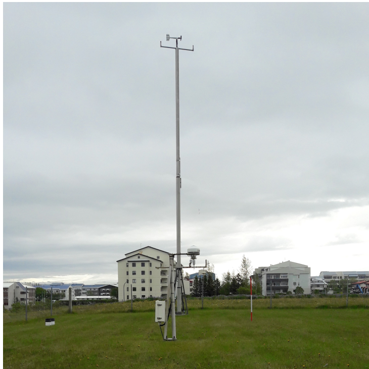
Mynd 51. Reykjavík: Horft til austurs yfir veðurreit VÍ. Heildargeislunarmælir fyrir miðri mynd og svo til beint vestur af honum, í tæplega 10 m fjarlægð, er 10 m mastur sjálfvirkur veðurstöðvarinnar í Reykjavík. Mynd tekin 25. júní 2021. Ljósmynd: Guðrún Nína Petersen.
