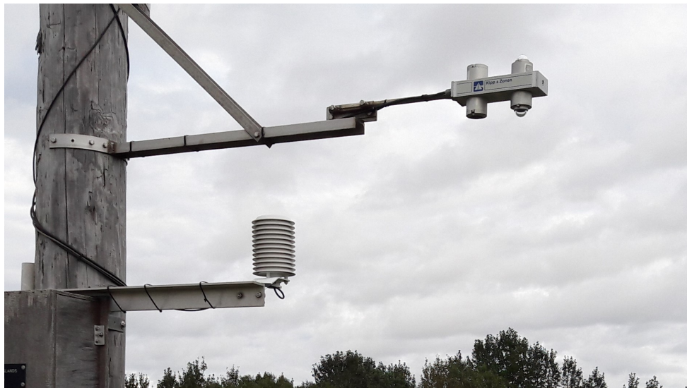
Mynd 6. Heildargeislunarmælar á Kálfhóli, frá Kipp & Zonen. Mælirinn samanstendur af fjórum geislunarmælum, hægra megin eru tveir heildarsólgeislunarmælar og vinstra megin tveir langbylgjumælar; í báðum tilvikum vísar annar mælirinn upp og hinn niður fyrir hvora tegund geislunar. Mynd tekin 12. september 2020. Ljósmynd: Guðrún Nína Petersen.
