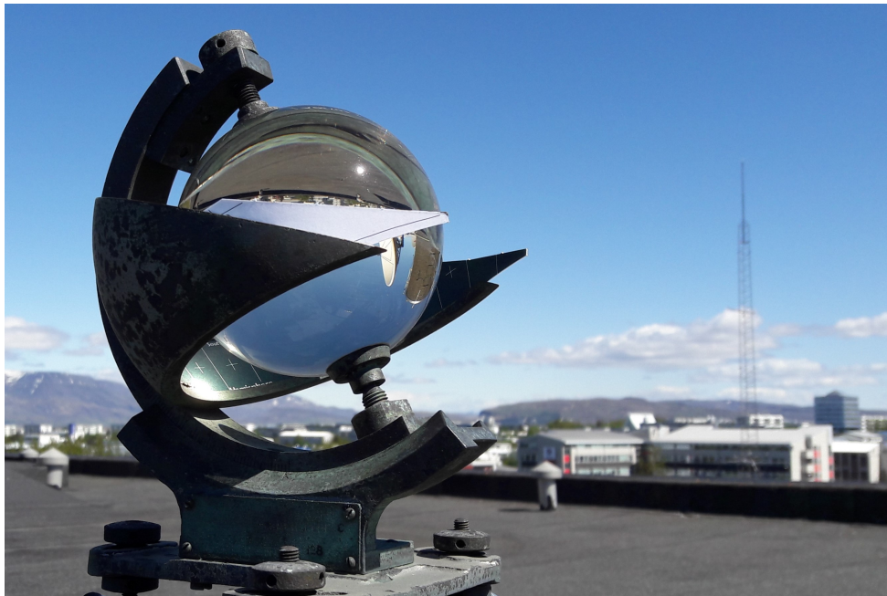
Mynd 4. Campbell-Stokes sólskinsstundamælir á þaki Veðurstofu Íslands. Þvermál glerkúlunnar er 10 cm. Mynd tekin 4. júní 2020. Ljósmynd: Guðrún Nína Petersen.
