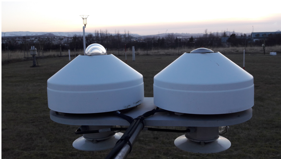
Mynd 3. Geislunarmælar í mælireit Veðurstofu Íslands. Vinstra megin eru tveir heildarsólgeislunarmælar og hægra megin tveir langbylgjumælar, annar mælirinn vísar upp og hinn niður fyrir hvora tegund, til að mæla geislun frá himni og yfirborði. Þvermál efri mælanna er 15 cm. Mynd var tekin 4. desember 2020. Ljósmynd: Guðrún Nína Petersen.
