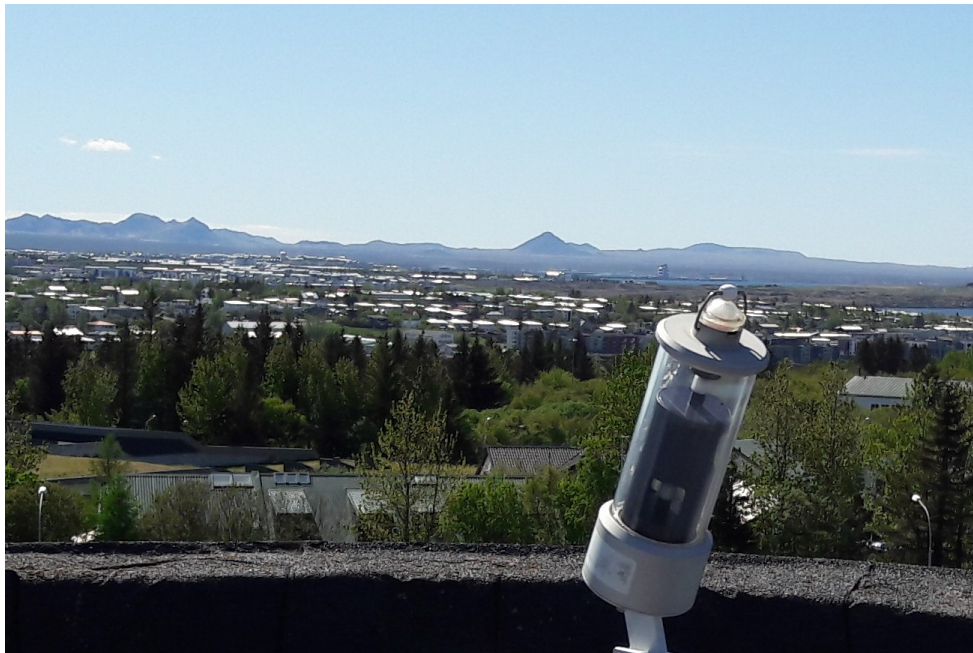
Mynd 5. Kipp & Zonen CSD sólskinsstundamælir á þaki Veðurstofu Íslands. Mynd tekin 4. júní 2020. Ljósmynd: Guðrún Nína Petersen
