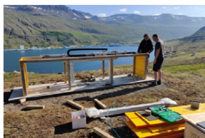
Frá uppsetningu radarsins í ágúst 2021. Radarinn hreyfist á sleða sem sést á myndinni og felst virkni hans í að skanna hlíðina frá tveimur mismunandi stöðum í hvert skipti. Ljósmynd: Vilhjálmur Kjartansson.
