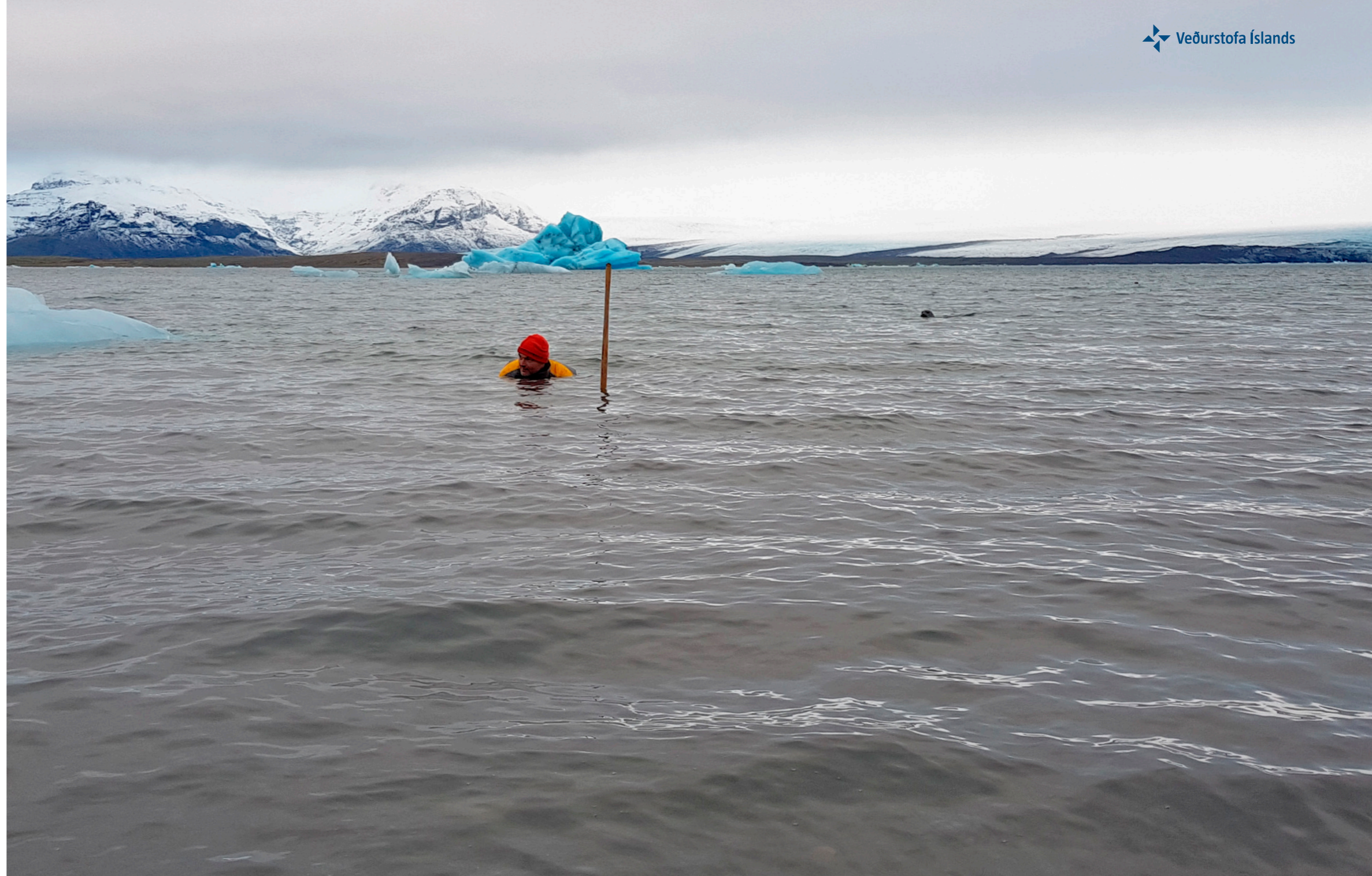
Skynjararör fyrir vatnshæðarmæli fest í Jökulsárlóni. Ljósmynd: Njáll Fannar Reynisson.
