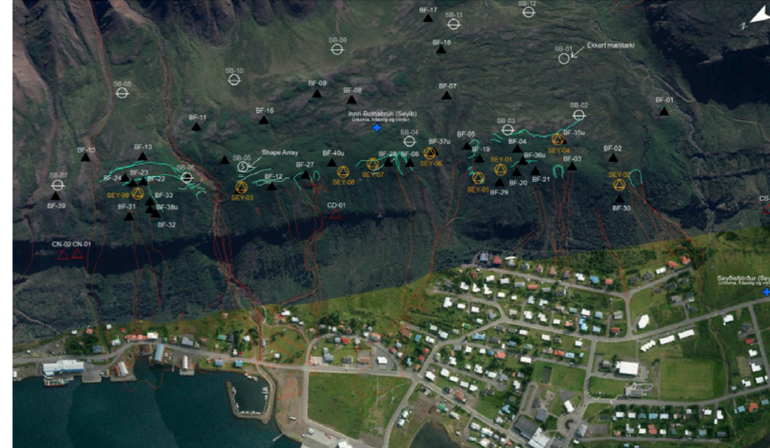
Öll mælitæki í Neðri-Botnum á Seyðisfirði haustið 2021. Speglaarnir eru auðkenndir með svörtu þríhyrningum, GPS stöðvar með appelsínugul þríhyrningum og borholur með hvítum hringjum. Vatnshæðarmælir í borholum eru auðkenndir með lárétttri línu í gegnum borholuhringina og aflögunarmælir með lóðrétttri síkksakk línu. Sprungur sem opnuðust í desember 2020 eru sýndar með grænum línunum og útlínur skriðanna með rauðum línunum. Mynd: Veðurstofa Íslands.
