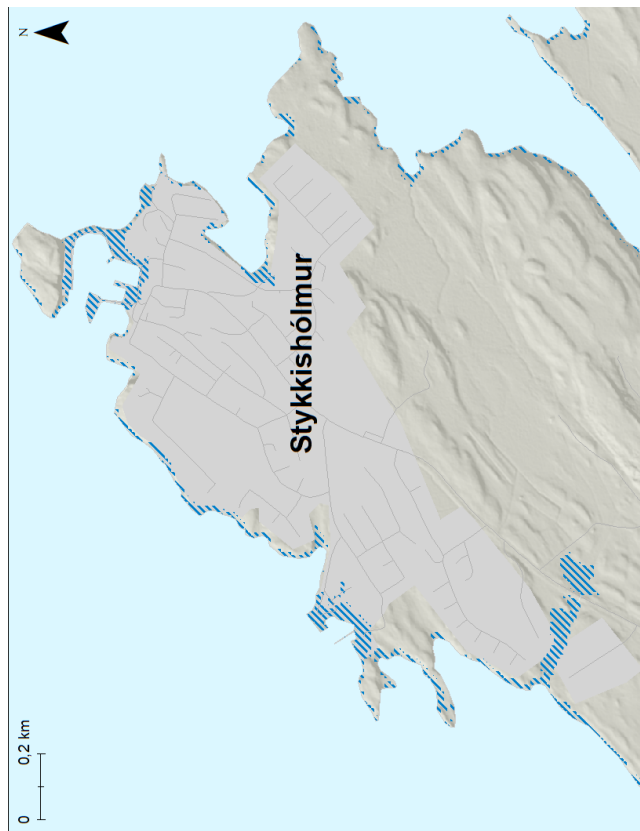
Mynd 171. Stykkishólmur. Möguleg útbreiðsla sjávarflóðs sem hefur 20 ára endurkomutíma (5% árslíkur) árið 2100 miðað við sviðsmynd SSP5-8.5LC.
