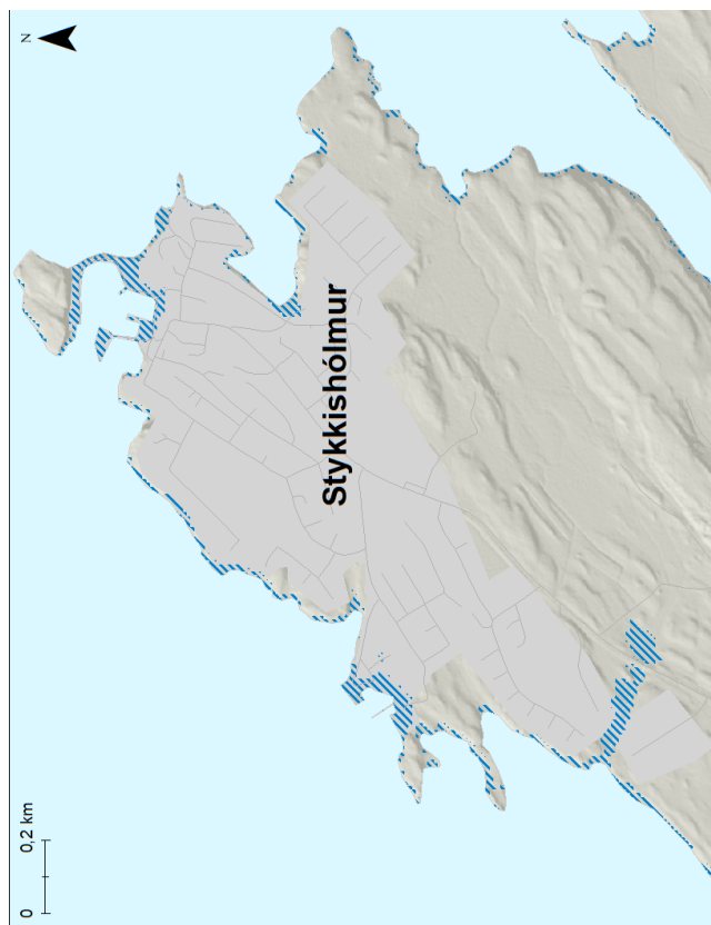
Mynd 177. Stykkishólmur. Möguleg útbreiðsla sjávarflóðs sem hefur 200 ára endurkomutíma (0,5% árslíkur) árið 2100 miðað við sviðsmynd SSP5-8.5.
