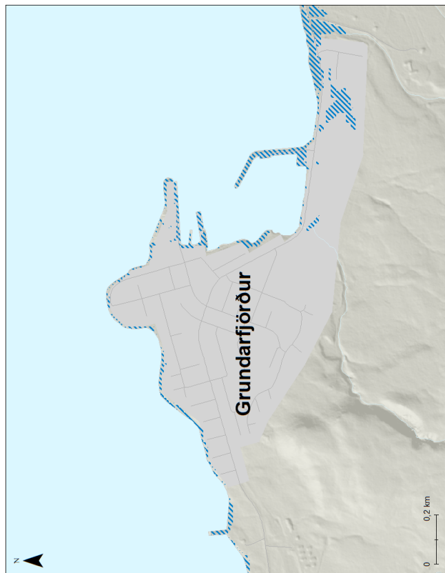
Mynd 160. Grundarfjörður. Möguleg útbreiðsla sjávarflóðs sem hefur 50 ára endurkomutíma (2% árslíkur) árið 2100 miðað við sviðsmynd SSP5-8.5LC.
