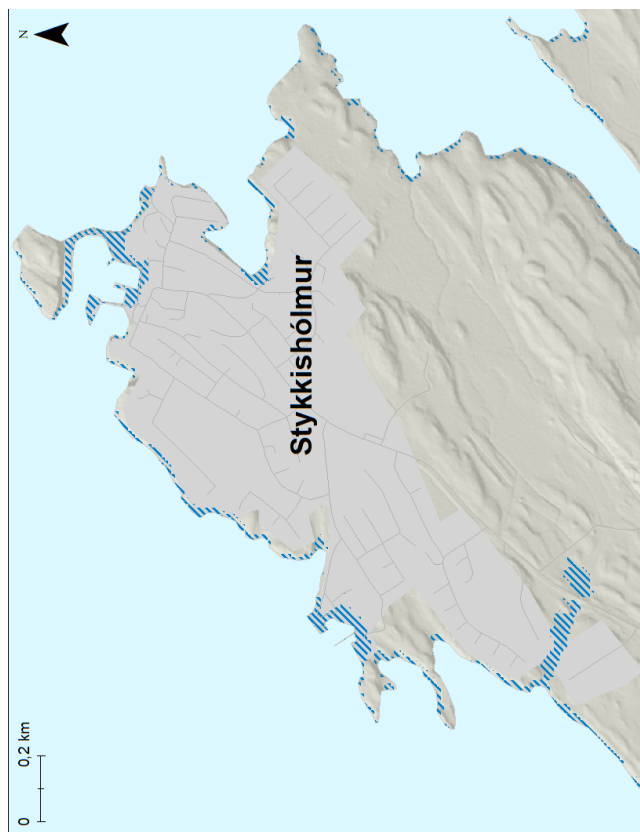
Mynd 173. Stykkishólmur. Möguleg útbreiðsla sjávarflóðs sem hefur 50 ára endurkomutíma (2% árslíkur) árið 2100 miðað við sviðsmynd SSP5-8.5.
