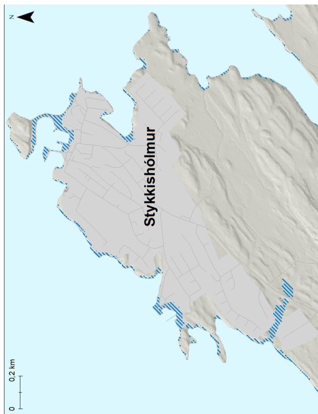
Mynd 169. Stykkishólmur. Möguleg útbreiðsla sjávarflóðs sem hefur 20 ára endurkomutíma (5% árslíkur) árið 2100 miðað við sviðsmynd SSP5-8.5.
