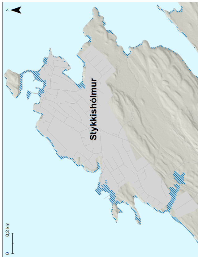
Mynd 179. Stykkishólmur. Möguleg útbreiðsla sjávarflóðs sem hefur 200 ára endurkomutíma (0,5% árslíkur) árið 2100 miðað við sviðsmynd SSP5-8.5LC.
