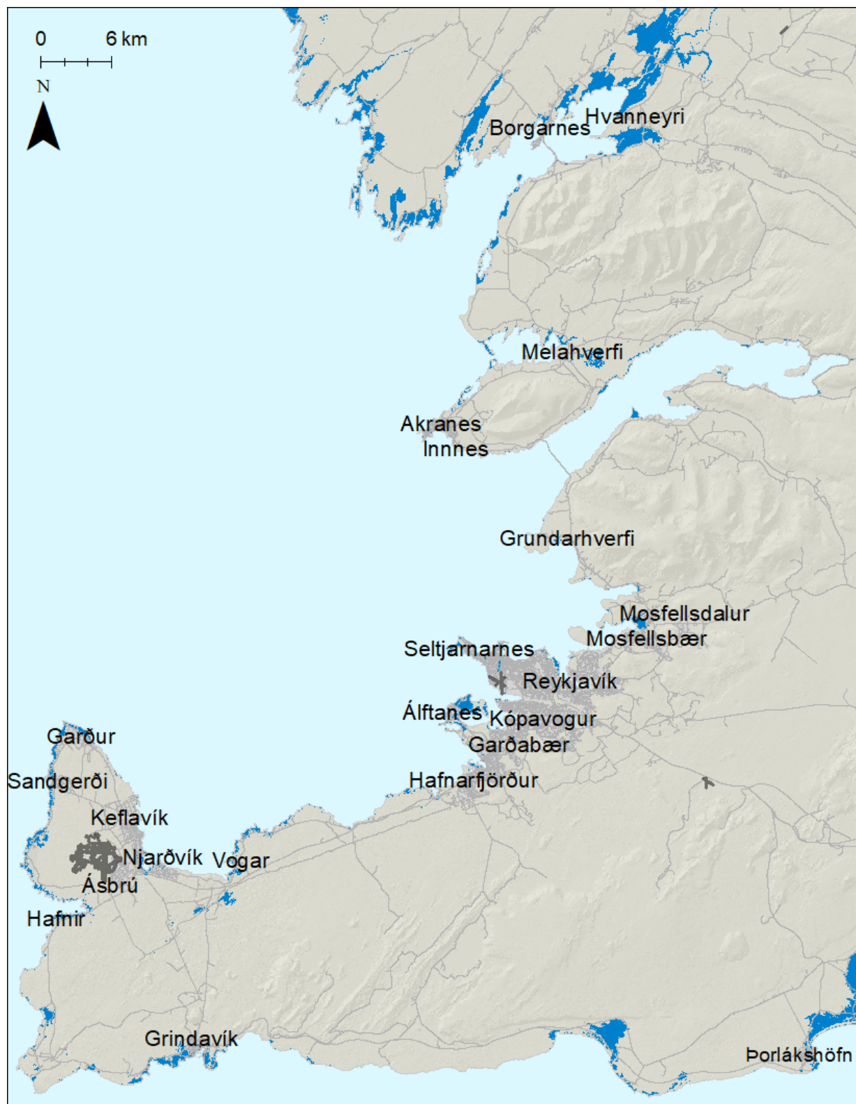
Mynd 130. Faxaflói. Möguleg útbreiðsla sjávarflóðs sem hefur 50 ára endurkomutíma (2% árslíkur) árið 2150 miðað við sviðsmynd SSP5-8.5LC.
