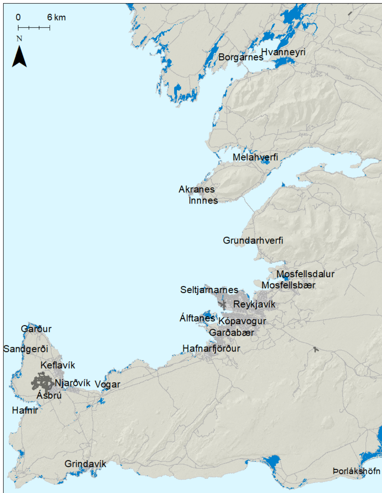
Mynd 135. Faxaflói. Möguleg útbreiðsla sjávarflóðs sem hefur 200 ára endurkomutíma (0,5% árslíkur) árið 2150 miðað við sviðsmynd SSP5-8.5LC.
