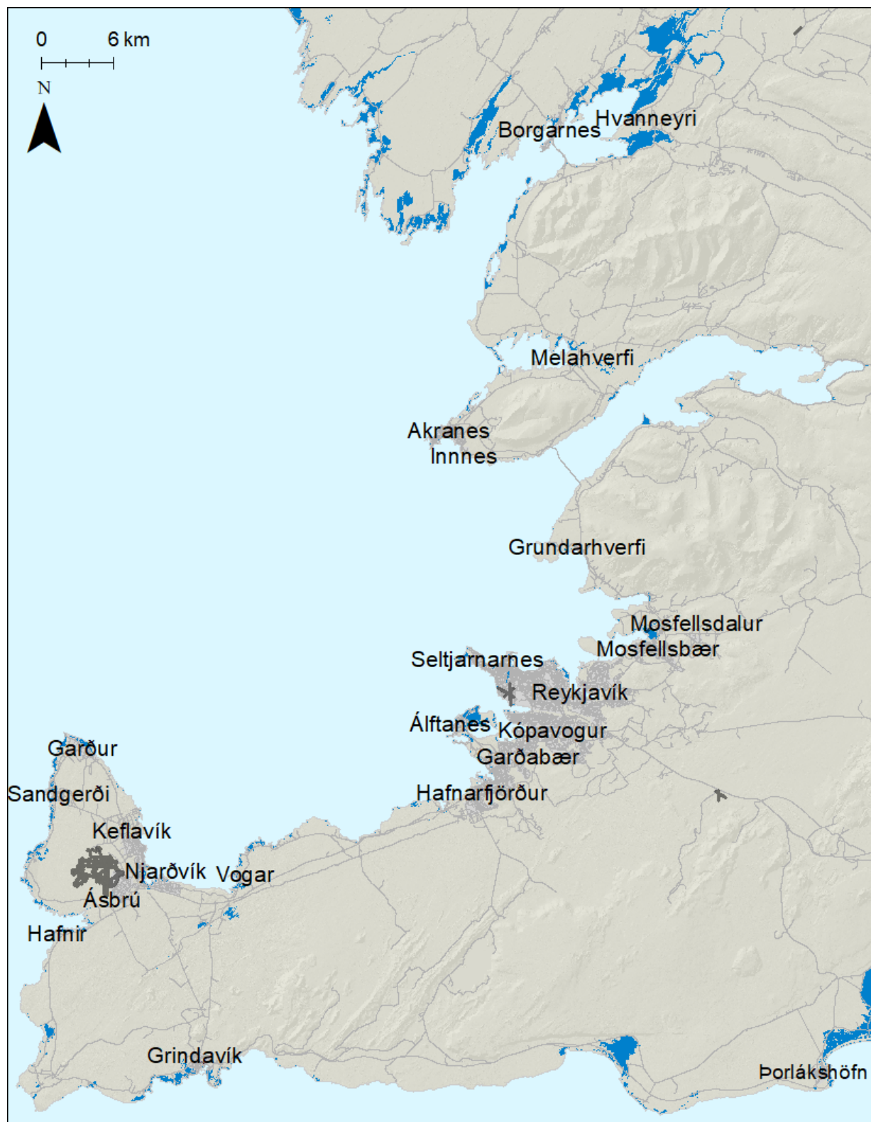
Mynd 128. Faxaflói. Möguleg útbreiðsla sjávarflóðs sem hefur 50 ára endurkomutíma (2% árslíkur) árið 2100 miðað við sviðsmynd SSP5-8.5LC.
