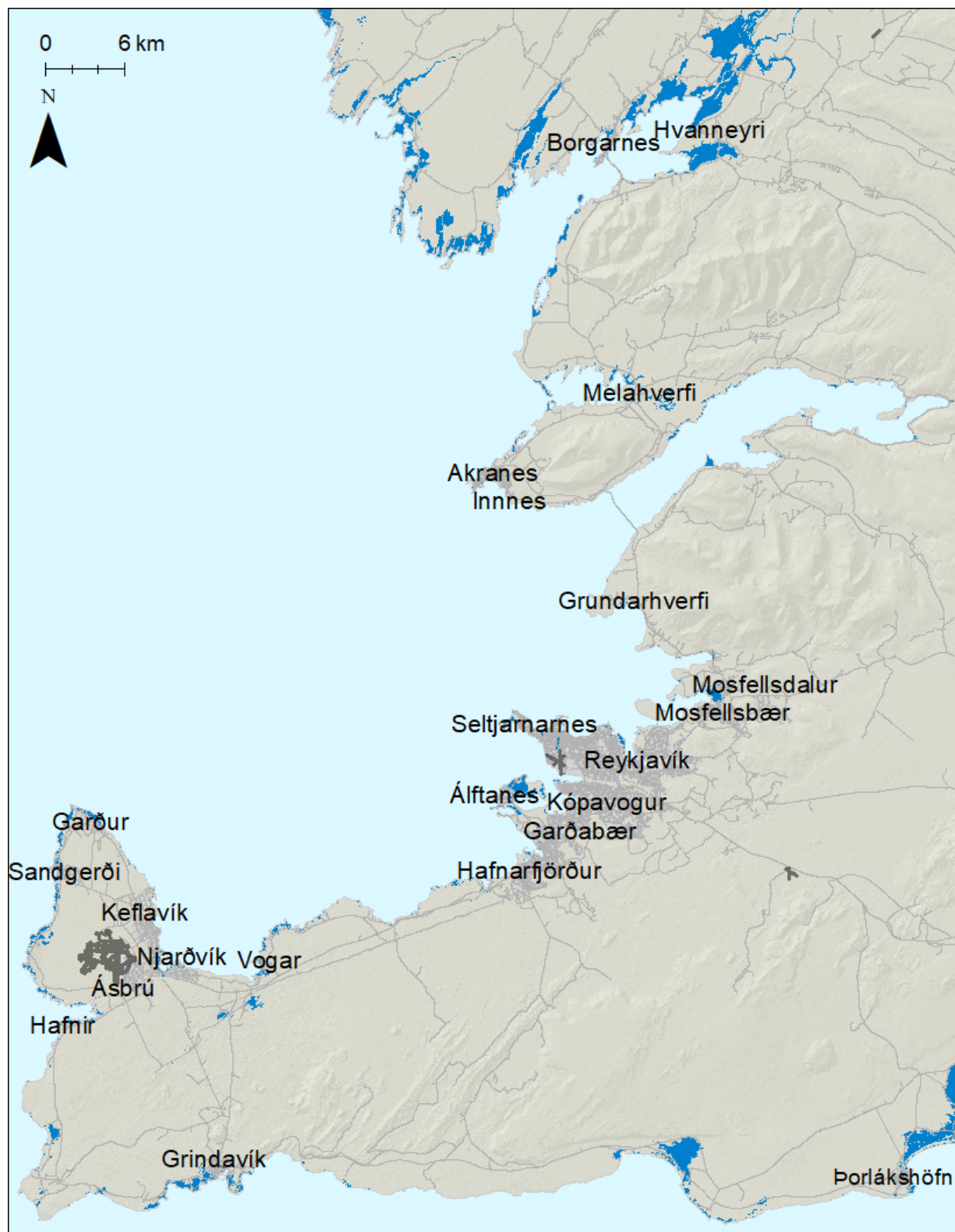
Mynd 133. Faxaflói. Möguleg útbreiðsla sjávarflóðs sem hefur 200 ára endurkomutíma (0,5% árslíkur) árið 2100 miðað við sviðsmynd SSP5-8.5LC.
