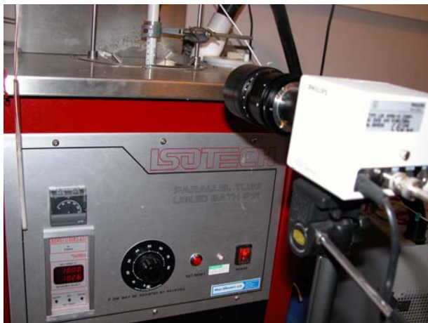
Mynd 13. Prófun hitamæla - lesið af með myndavél.
