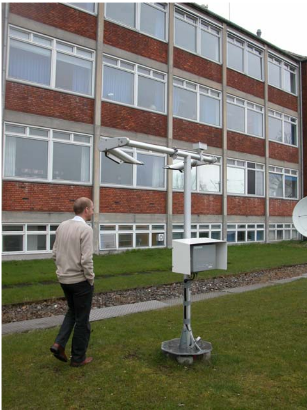
Mynd 21. Sjálfvirkur veðurskynjari og skyggnismælir.
