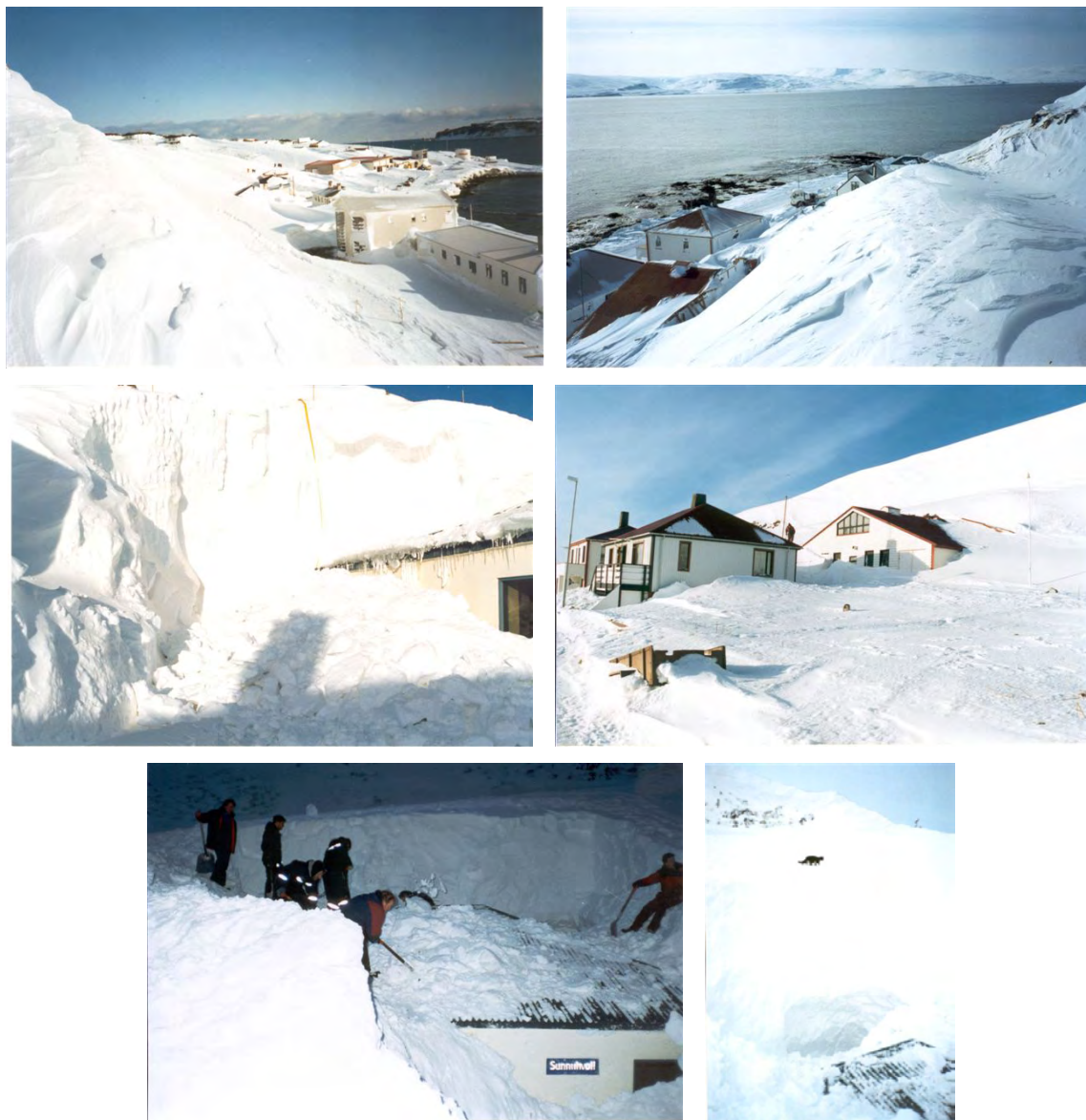
Mynd 7. Snjóalög í brekkunni upp af Aðalbraut í janúar 1995. Efst til vinstri: Brekkan ofan skólans að Aðalbraut 10. Horft er út eftir byggðinni. Efst til hægri: Skafl ofan fjárhússins og hlöðunnar að Aðalbraut 6. Þak hlöðunnar hefur sigið undan farginu. Horft er inn eftir byggðinni. Miðröð: Snjór ofan á þaki fjárhússins og hlöðunnar að Aðalbraut 6. Neðsta röð: Menn og málleysingjar að störfum við að moka snjó af þaki Sunnuhvols, Aðalbraut 18. Ljósmyndir frá Jóni Herði Elíassyni.
